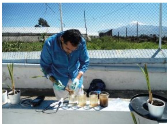
Experimentación para comprobar la absorción de plomo en el rizoma de T. latifolia Foto: Autores
